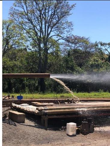
Fotografía 3. Prueba de soplado pozo exploratorio, 10/02/20
